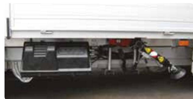
Smart placering av hydraulaggregat, lättåtkomligt för service.
