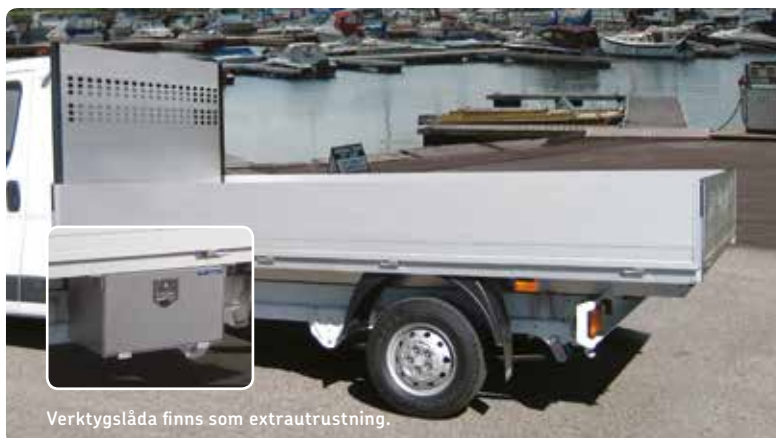
Flaklängd från 4000 mm har delade sidolämmar.
