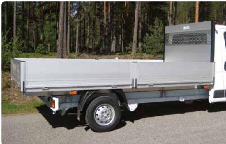
Flaklängd från 4000 mm har delade sidolämmar.
