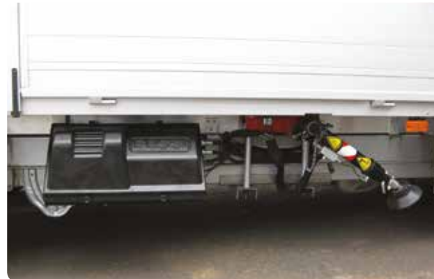
Smart placering av hydraulaggregat, lättåtkomligt för service.
