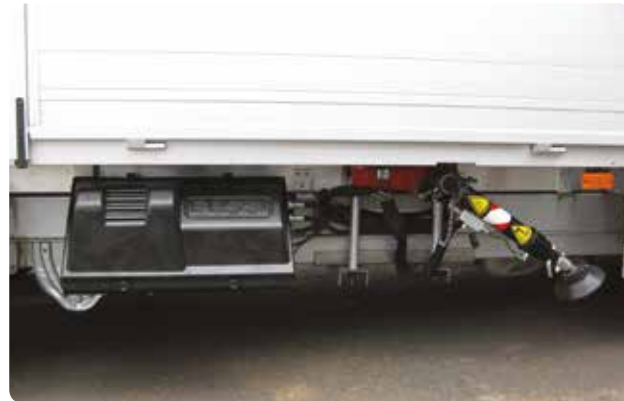
Smart placering av hydraulaggregat, lättåtkomligt för service.
