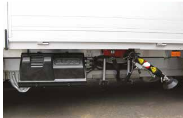
Smart placering av hydraulaggregat, lättåtkomligt för service.
