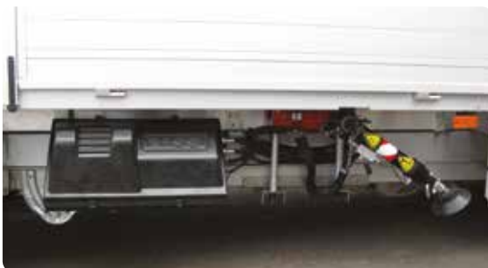
Smart placering av hydraulaggregat, lättåtkomligt för service.
