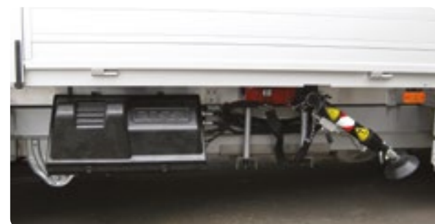
Smart placering av hydraulaggregat, lättåtkomligt för service.
