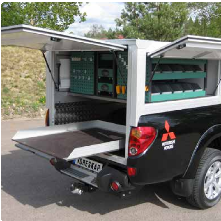
Inredning, mellangolv och lastsläde finns som tillval till Y1-Kåpan.
