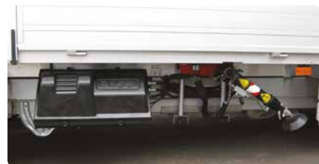
Smart placering av hydraulaggregat, lättåtkomligt för service.
