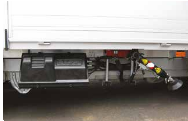
Smart placering av hydraulaggregat, lättåtkomligt för service.
